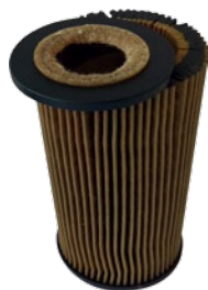
ผลิตภัณฑ์คู่แข่ง: ไม่ผ่านการทดสอบ ไส้กรองเสียหายเนื่องจากฝาครอบปลายหลุด
