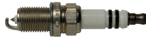
หัวเทียนของคู่แข่งรายหนึ่งก่อนการทดสอบฟั่นเกลียว 100 ชั่วโมง
