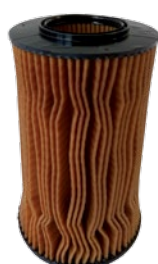
ผลิตภัณฑ์คู่แข่ง: ไม่ผ่านการทดสอบ รอยฉีกเสียหายอย่างมาก
